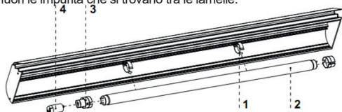
Rys. 12. Wymiana świetlówki w lampie
