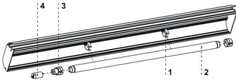
Abb.14 Austausch der Leuchtlampe 1 – Halterung der Leuchtlampe 2 – Leuchtlampe 3 – Leuchtlampe- und Zündergehäuse 4 – Zünder
