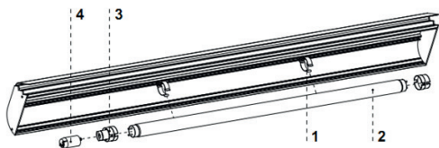
Rys. 12. Wymiana świetlówki w lampie
